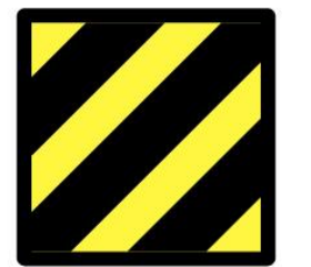
niet met water blussen
